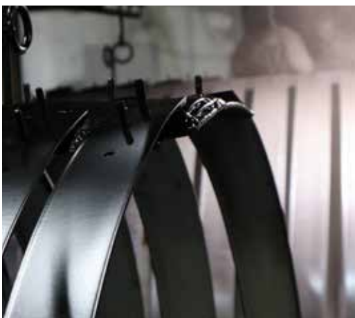
Pulverbeschichtung bietet hervorragenden Korrosionsschutz und echte Gestaltungsvielfalt, sodass sich auch Wunschfarben realisieren lassen
