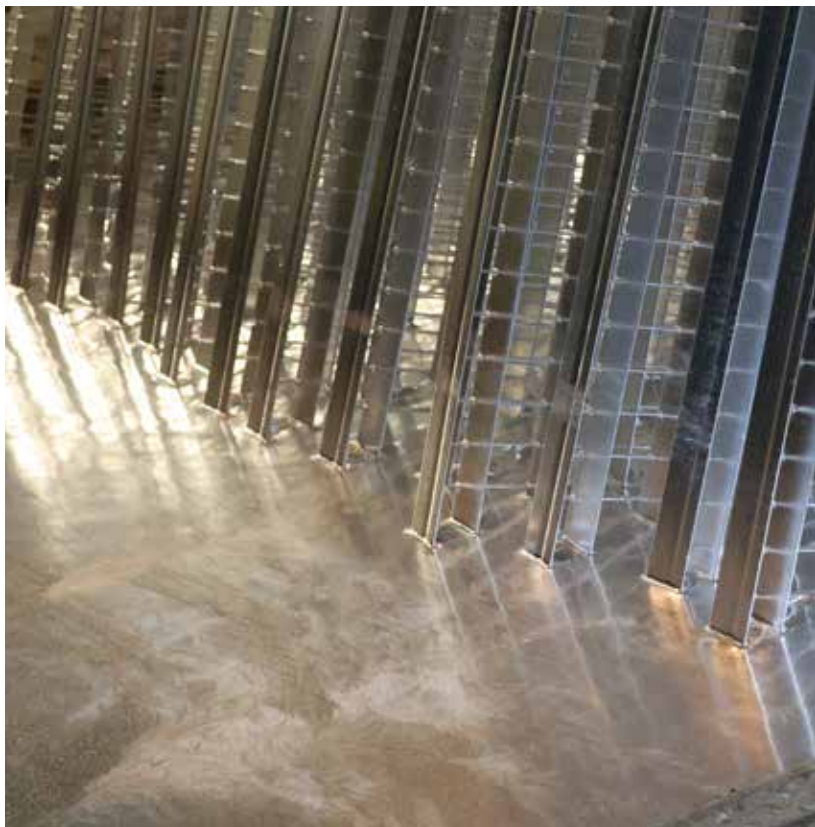
La galvanisation à la pièce permet d'atteindre même les zones difficiles d'accès et garantit ainsi une protection homogène de l'ensemble de la surface
