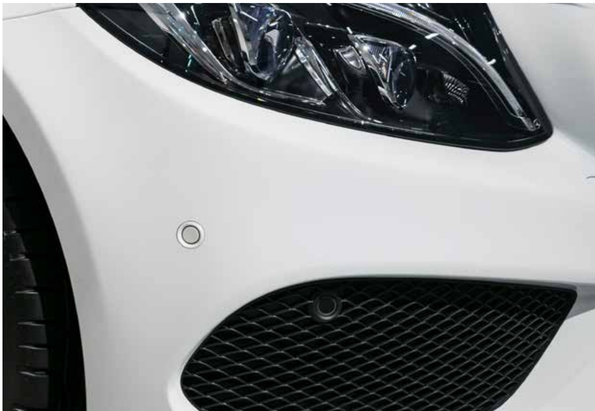
Streckmetall kommt in modernen Fahrzeugen zum Einsatz und überzeugt durch Stabilität bei geringem Gewicht
