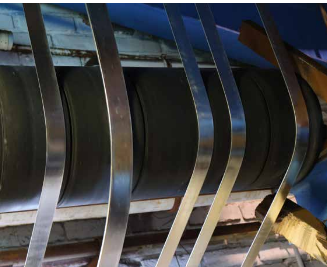
Via Bandverzinkung lässt sich eine gleichmäßige Oberfläche bei wirtschaftlicher Verarbeitung und konstant hoher Materialqualität gewährleisten
