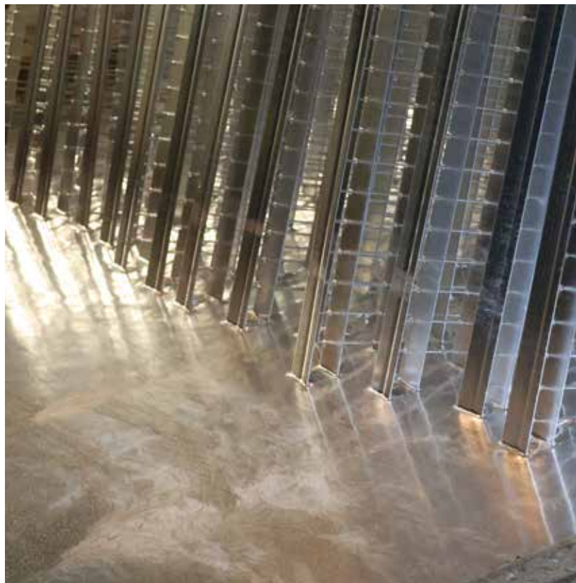
Stückverzinkung erreicht auch schwer zugängliche Bereiche und sorgt so für einen durchgängigen Schutz der gesamten Oberfläche
