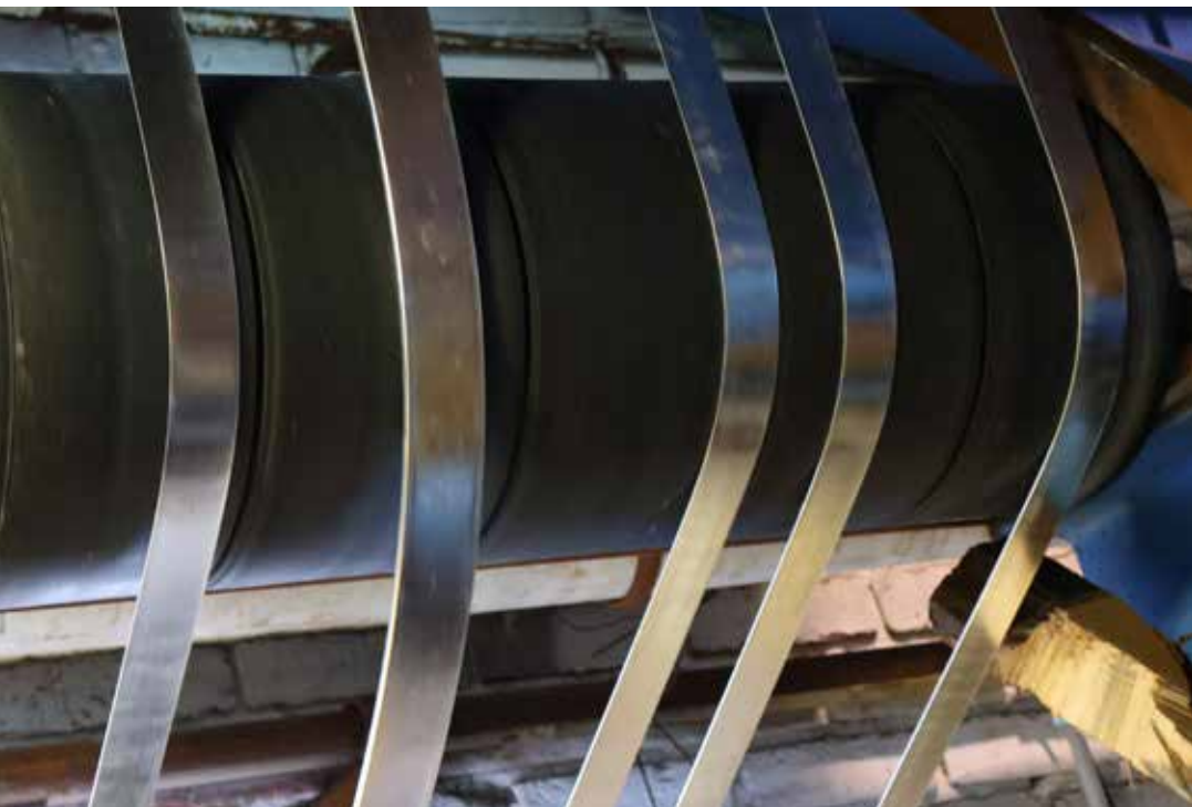
La galvanisation en continu permet d'obtenir une surface homogène tout en garantissant un procédé optimisé ainsi qu'une qualité élevée et constante du matériau
