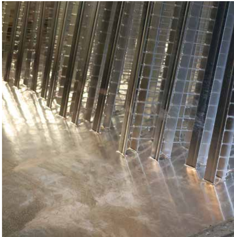
El galvanizado por piezas llega incluso a las zonas de difícil acceso, lo que garantiza una protección uniforme de toda la superficie
