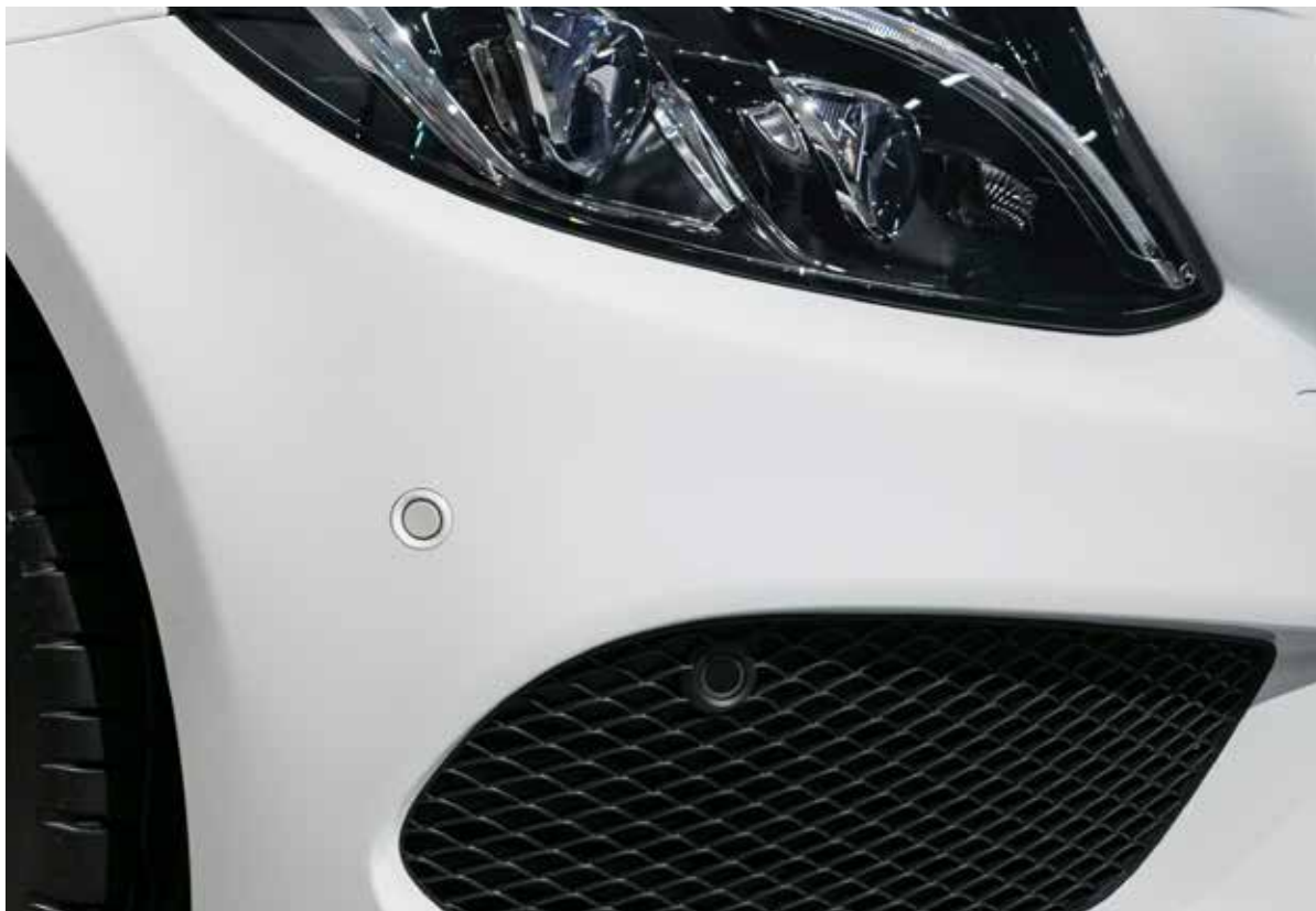
La chapa perforada se utiliza en los vehículos modernos y destaca por su estabilidad y su reducido peso
