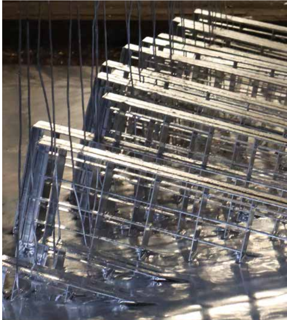
Stückverzinkung schützt dauerhaft vor Korrosion und sichert so eine robuste, wartungsarme Nutzung im Außenbereich
