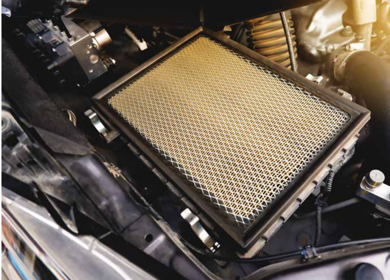
Innen- oder Motorluftfilter enthalten oft Streckmetall als Stütze für Papier- oder Vliesmedien
