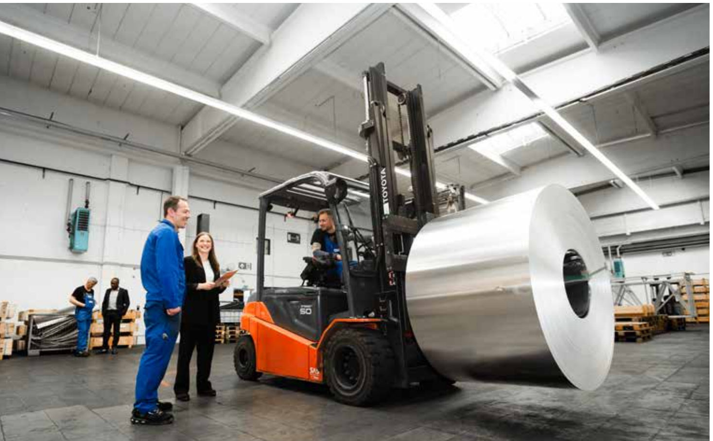
Transport eines Coils, dem Ausgangsmaterial für Streckmetall
